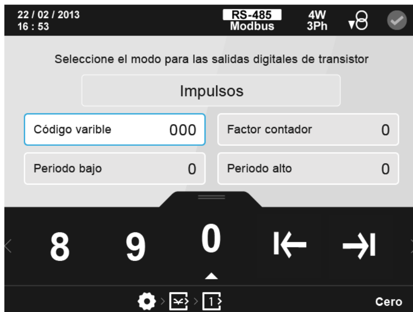
Figura 133: Pantalla de configuración de las salidas digitales de transistor ( modo impulsos).
