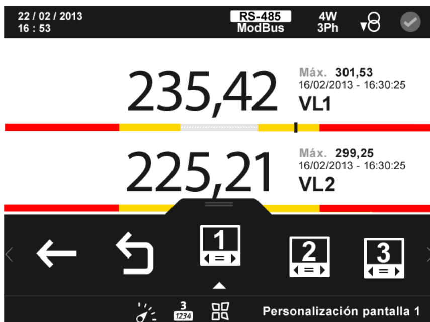
Figura 63: Pantalla de parámetros personalizados (visualizar 3 parámetro).
