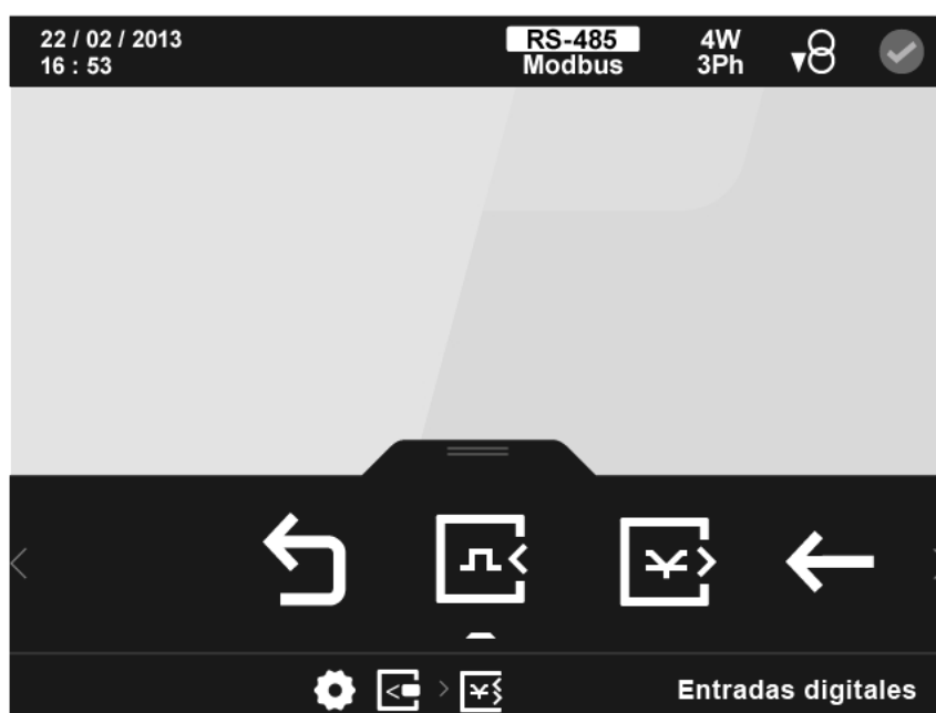
Figura 165: Pantalla principal de la configuración de las entradas/salidas digitales de transistor.
