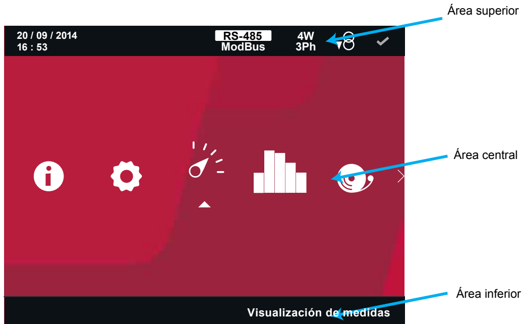
Figura 19: Áreas del display del CVM-B.
