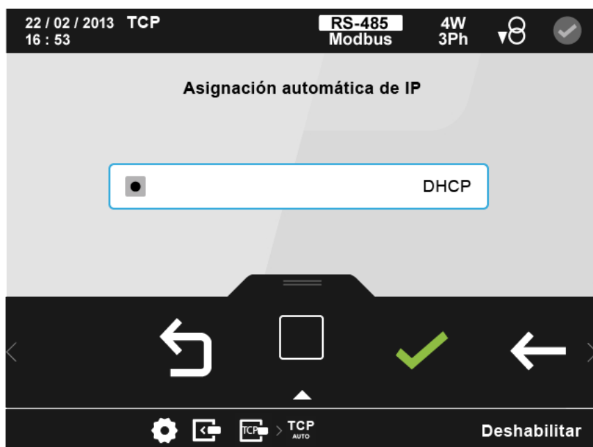
Figura 184: Pantalla de configuración del módulo Modbus TCP (Bridge) ( TCP Auto)
