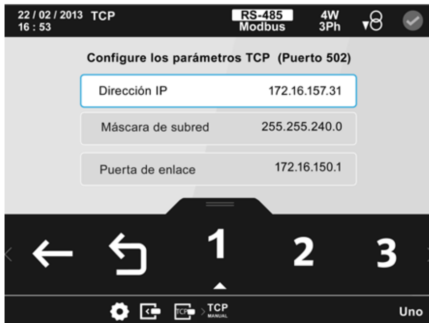
Figura 220: Pantalla de configuración del módulo Modbus TCP (Switch) ( TCP manual)
