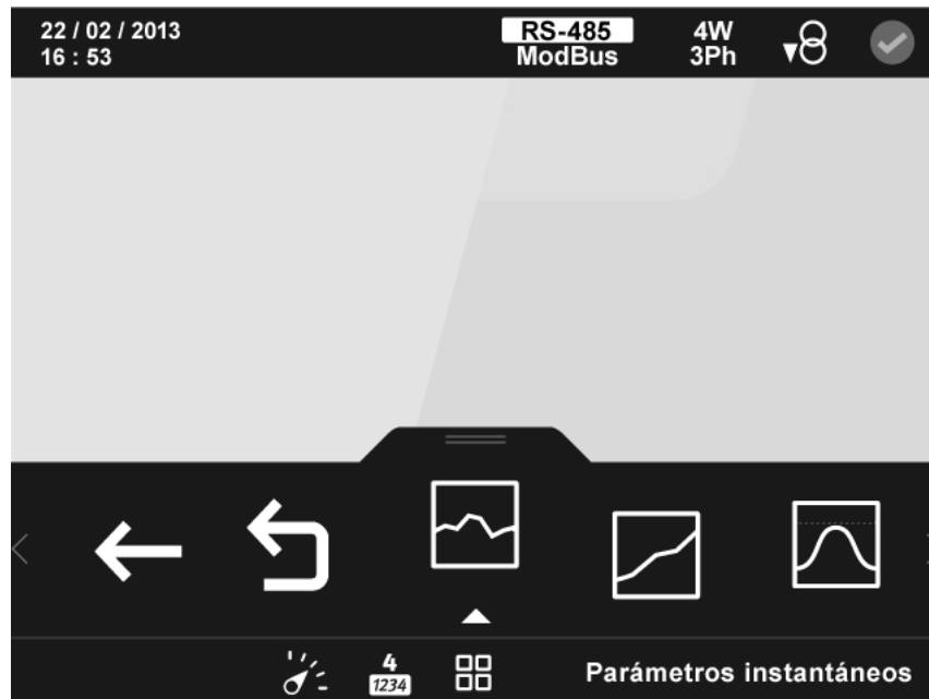
Figura 66: Pantalla de visualización de parámetros por defecto (visualizar 4 parámetros).
