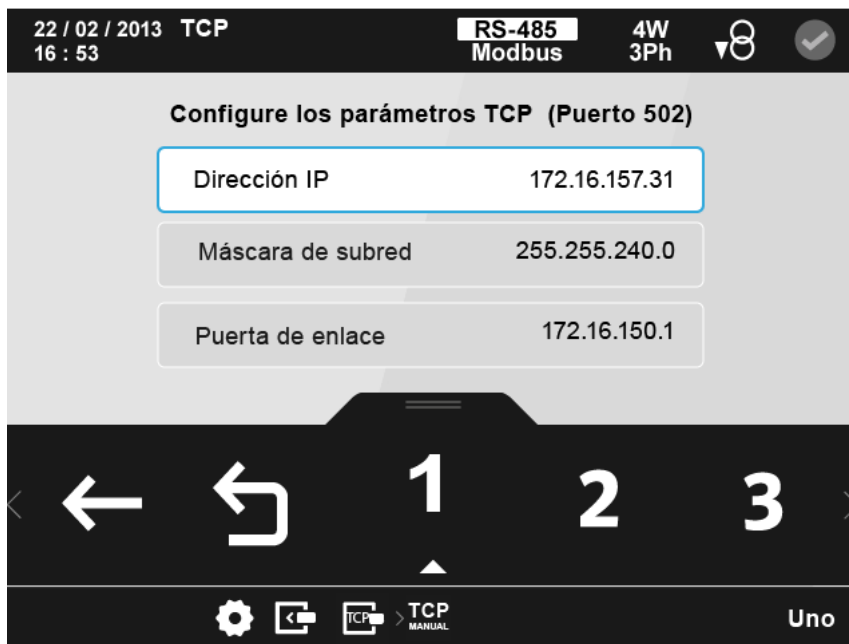
Figura 185: Pantalla de configuración del módulo Modbus TCP (Bridge) ( TCP manual)
