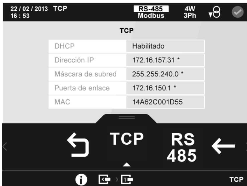
Figura 103: Pantalla de información del módulo Modbus TCP (Bridge) (Comunicación TCP).
