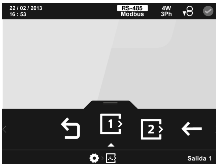
Figura 129: Pantalla principal de la configuración de las salidas digitales de relé.
