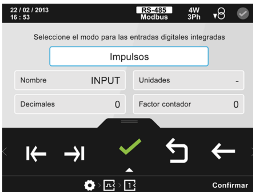
Figura 136: Pantalla de configuración de las entradas digitales ( modo impulsos).
