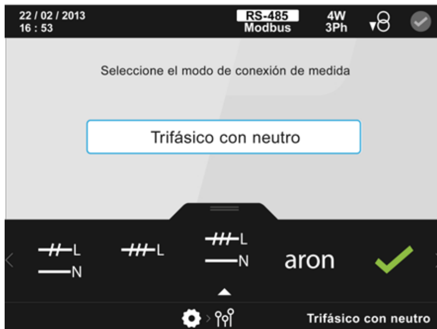
Figura 119: Pantalla de configuración del modo de conexión de la medida.
