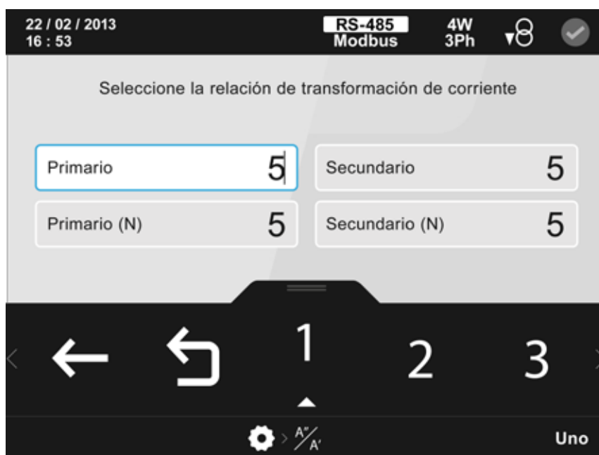
Figura 121: Pantalla de configuración de la relación de los transformadores de corriente.
