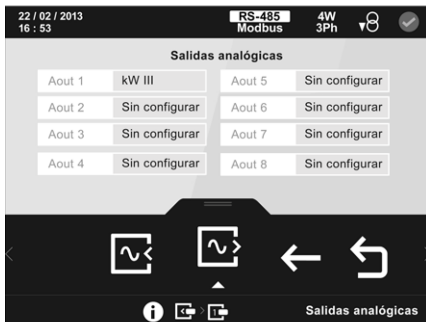
Figura 102: Pantalla de información de las salidas analógicas (Módulo Entradas/Salidas Analógicas)
