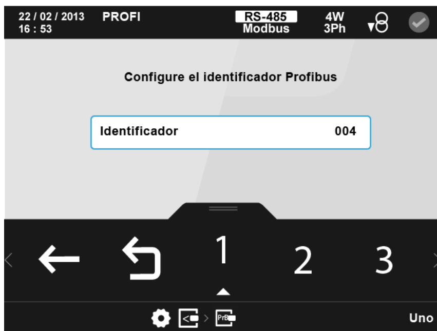
Figura 198: Pantalla principal de configuración del módulo Profibus
