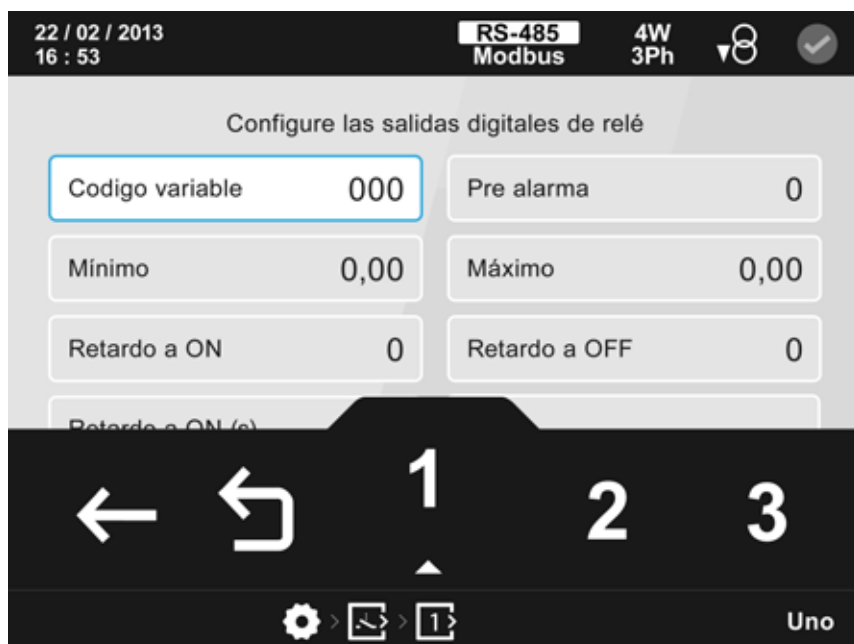
Figura 130: Pantalla de configuración de las salidas digitales de relé.
