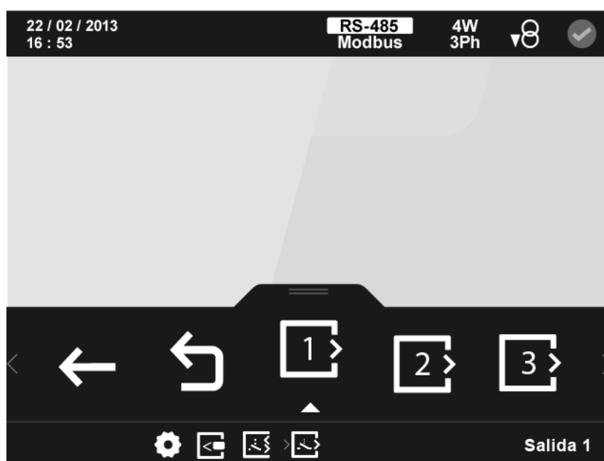
Figura 158: Pantalla principal de la configuración de las salidas digitales de relé.
