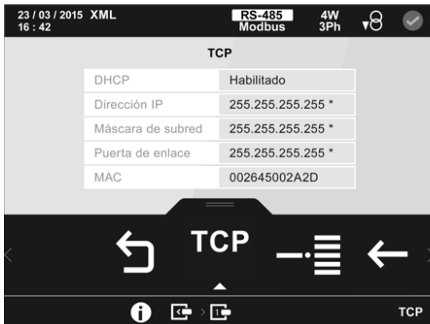
Figura 108: Pantalla de información del módulo Modbus Datalogger (TCP)
