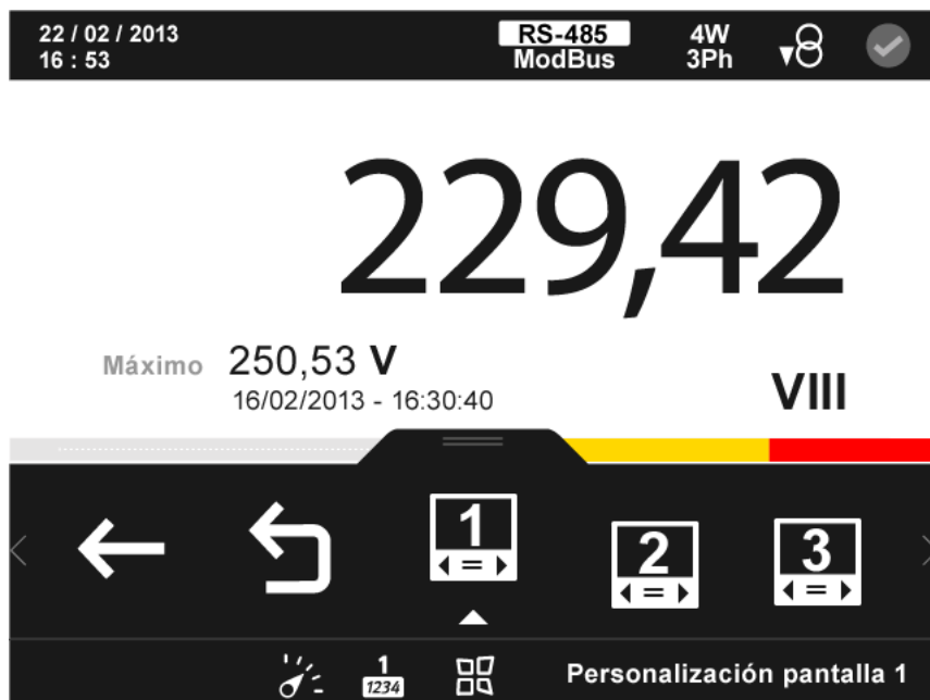
Figura 44: Pantalla de parámetros personalizados (visualizar 1 parámetro).
