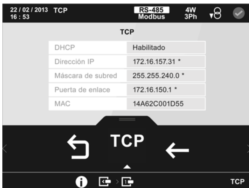
Figura 110: Pantalla de información del módulo Modbus TCP (Switch) (Comunicación TCP).
