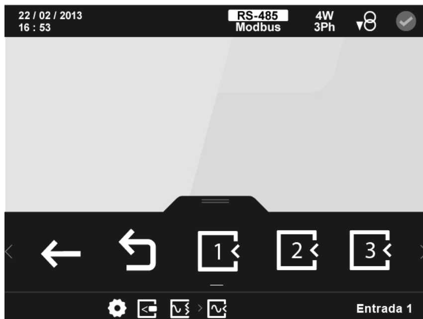
Figura 174: Pantalla principal de la configuración de las entradas analógicas.
