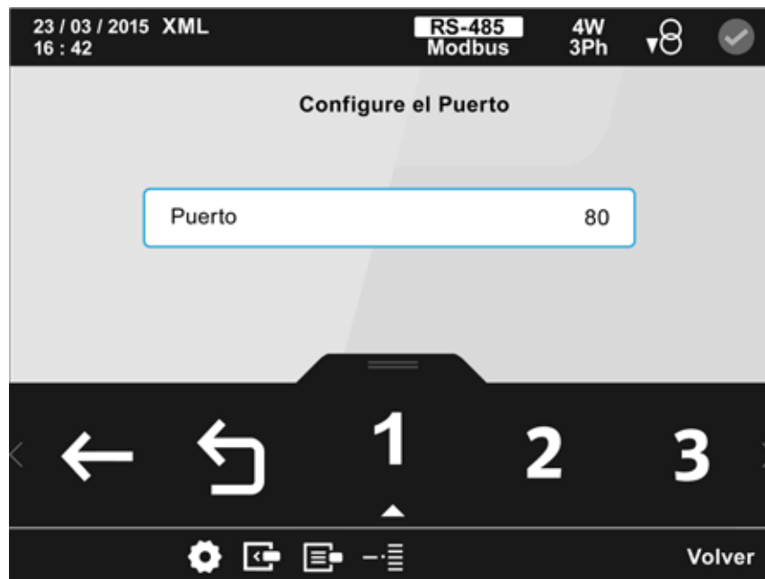
Figura 212: Pantalla de configuración del puerto.
