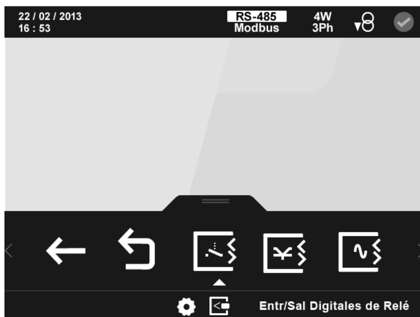
Figura 172: Pantalla principal de los módulos de expansión.
