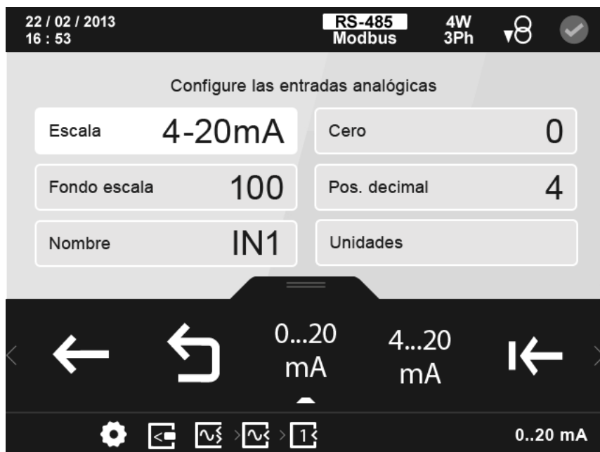
Figura 175: Pantalla de configuración de las entradas analógicas.
