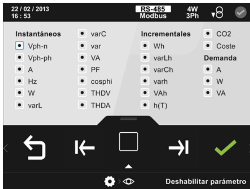
Figura 123: Pantalla de configuración de la visualización de variable.
