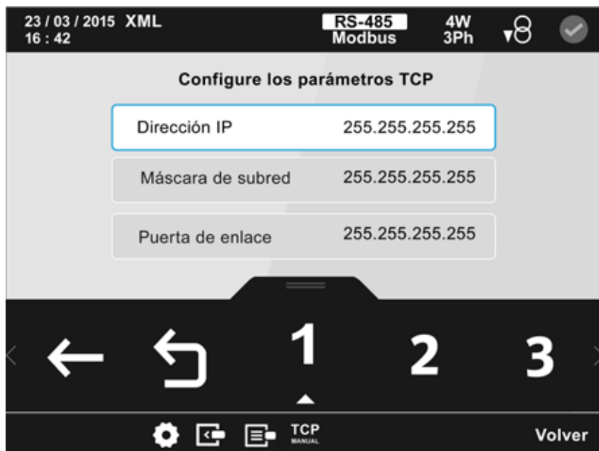
Figura 211: Pantalla de configuración del módulo Datalogger ( TCP Manual)
