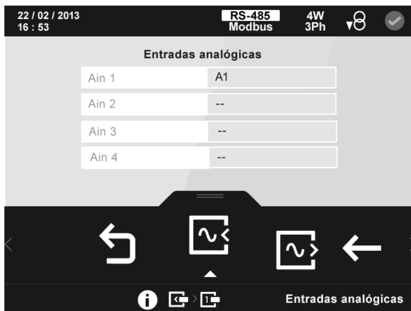
Figura 101: Pantalla de información de las entradas analógicas (Módulo Entradas/Salidas Analógicas).
