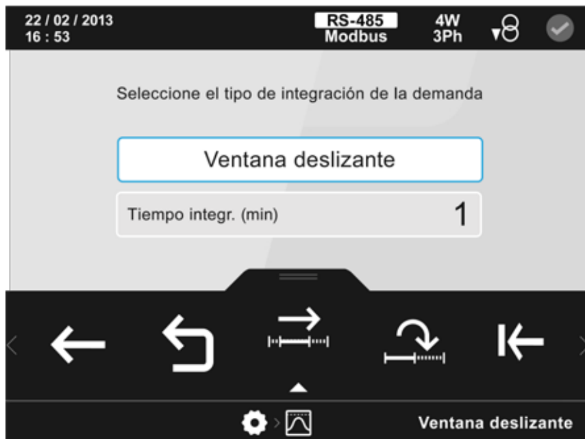
Figura 124: Pantalla de configuración de los parámetros de máxima demanda.
