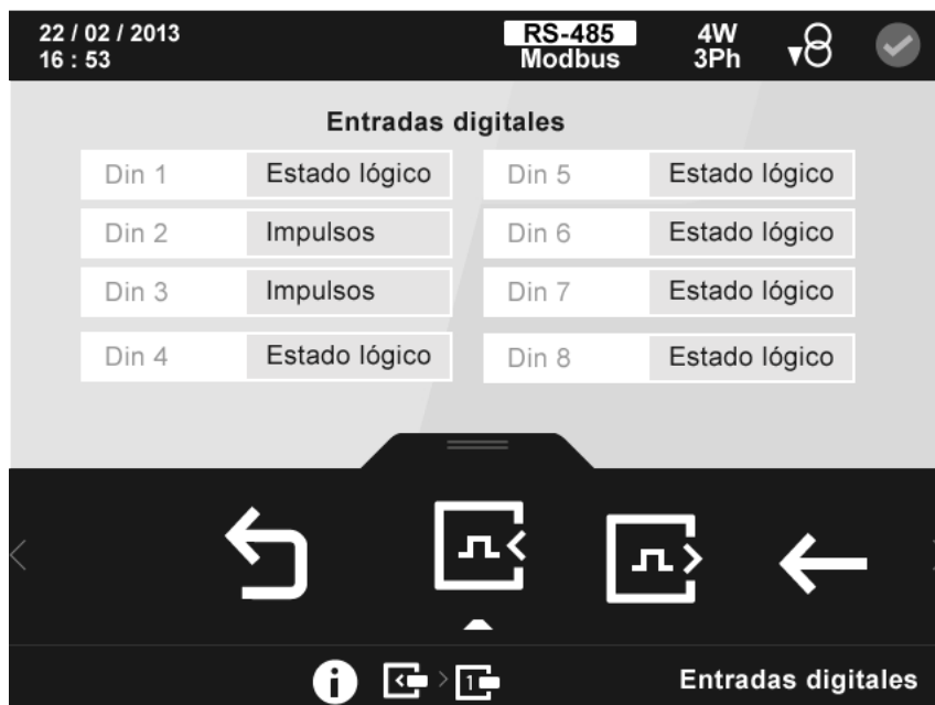
Figura 99: Pantalla de información de las entradas digitales (Módulo Entradas/Salidas digitales de Transistor).
