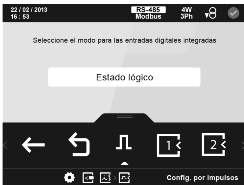
Figura 157: Pantalla principal de la configuración de las entradas digitales de relé.
