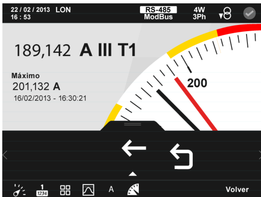
Figura 42:Parámetros de demanda, visualización analógica ( visualizar 1 parámetro).
