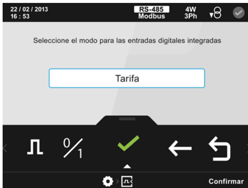
Figura 135: Pantalla de configuración de las entradas digitales ( modo tarifa).
