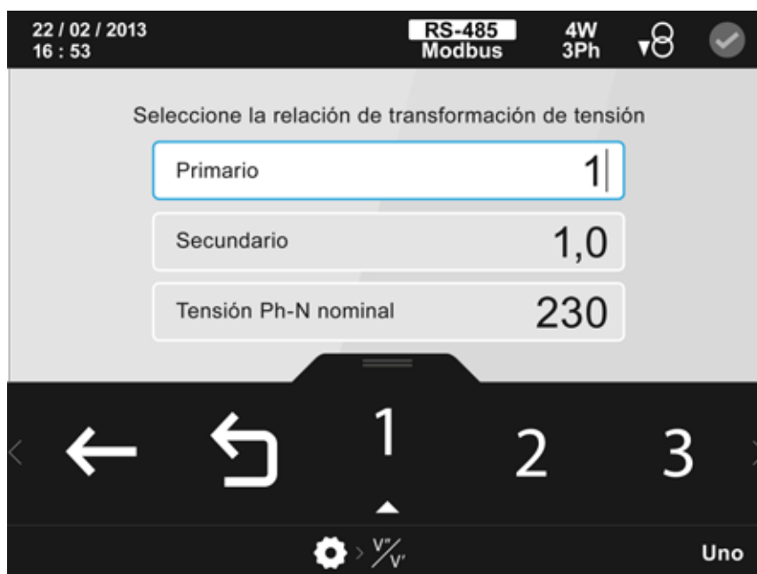
Figura 120: Pantalla de configuración de la relación de los transformadores de tensión.
