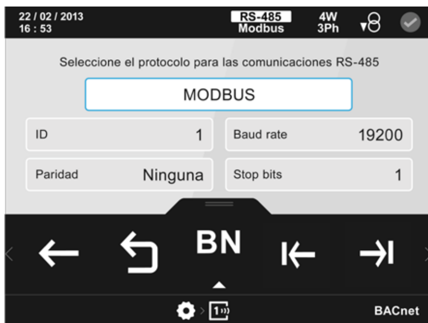
Figura 138: Pantalla de configuración de las comunicaciones integradas ( protocolo Modbus).
