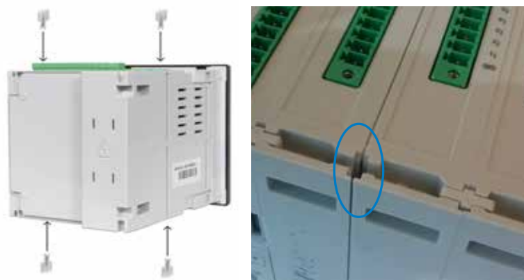
Figura 149: Introducir los clips de sujeción en las ranuras correspondientes.
