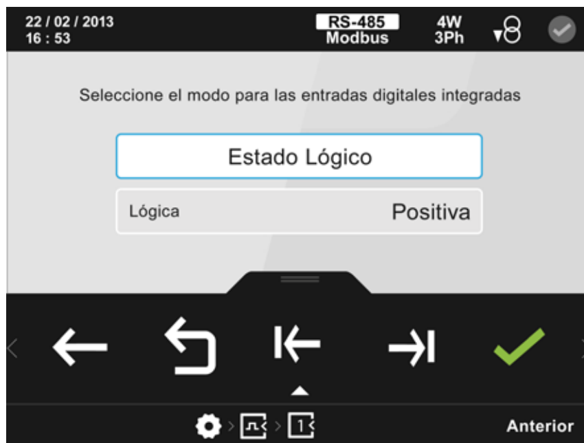
Figura 137: Pantalla de configuración de las entradas digitales ( modo estado lógico).
