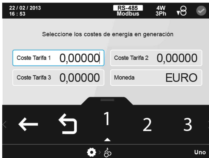
Figura 126: Pantalla de configuración de los costes de energía en generación.
