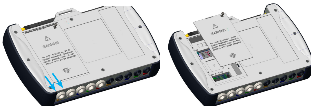
Figura 2: Extracción de cubierta de la batería.
